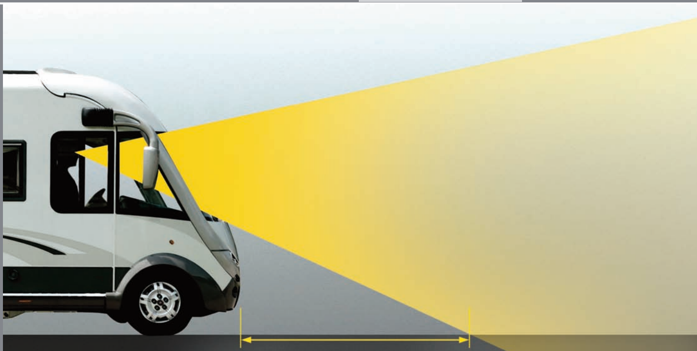
optimiertes Sichtfeld durch tief angesetzte Frontscheibe und steil abfallendes Armaturenbrett
